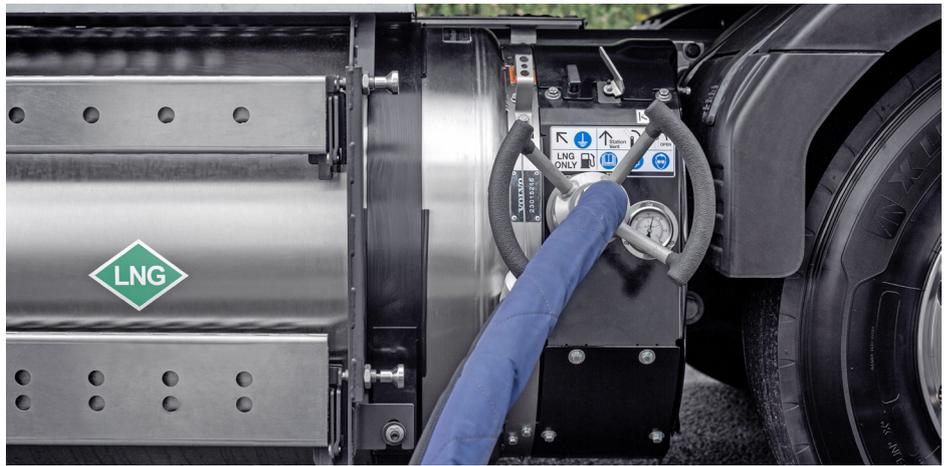
Interessante Alternative, die bereits flächendeckend eingesetzt werden kann und bis zu 20 Prozent der CO<sub>2</sub>-Emissionen auf einen Schlag reduziert: Flüssigerdgas. Die Reichweite ist in etwa gleich wie mit Dieselantrieb, und der Tankvorgang ist ebenfalls rasch vollzogen. Mit Flüssigbiogas fährt es sich quasi CO<sub>2</sub>-neutral. Foto: Volvo
