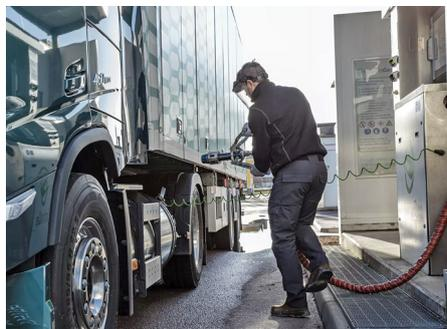
Das verflüssigte Gas wird mit einer Temperatur von unter -160°C betankt. Entsprechende Vorsichtsmassnahmen beim Betankungsvorgang schützen vor Kälteverbrennungen mit dem tiefkalten Treibstoff und dem tiefkalten Einfüllstutzen. Foto: Volvo
